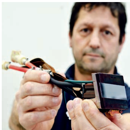
2.048 Düsen auf kleinstem Raum: Salvatore Tripoli zeigt einen der 160 Druckköpfe.
